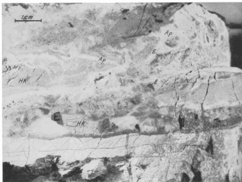
Abb. 9. Innerer Kontaktbereich, Anschliffbild. Hornsteinkalkbrocken (HK), Apophyllitadern und -massen (Ap), Ehrwalditfetzen (E).
